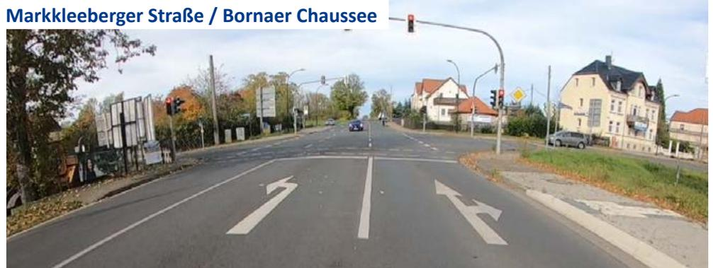
Der Knoten Markkleeberger Straße / Bornaer Chaussee verfügt über keinerlei Radverkehrsanlagen und ist noch dazu mit hohen Schwerverkehrsanteilen besonders unsicher. Es wird dringend empfohlen, für künftige Radwege entlang der Bornaer Chaussee sichere Einbindungen im Knotenbereich zu schaffen.
