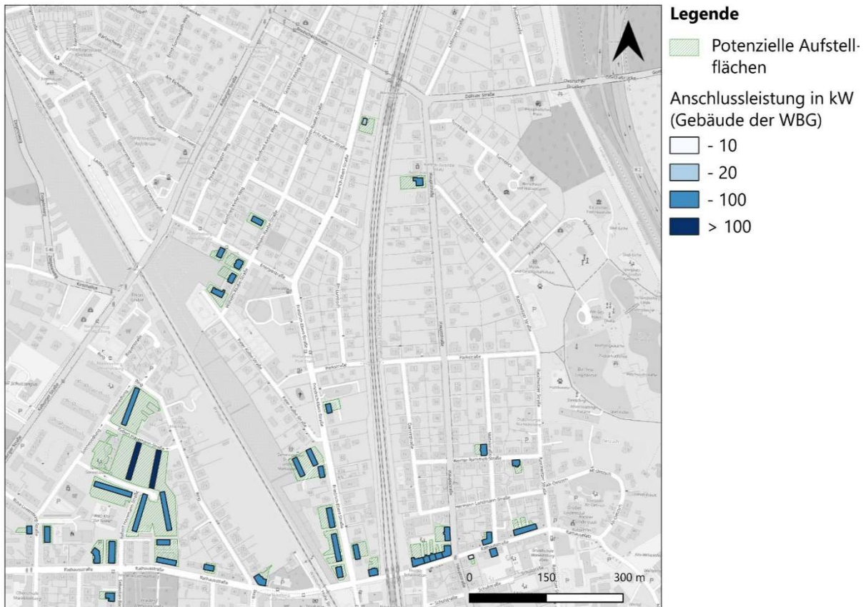
Abbildung 35 Analyse der potenziellen Aufstellflächen für die Außeneinheiten von dezentralen Luft-WP (Quelle: eigene Darstellung, Hintergrundkarte: [40])
